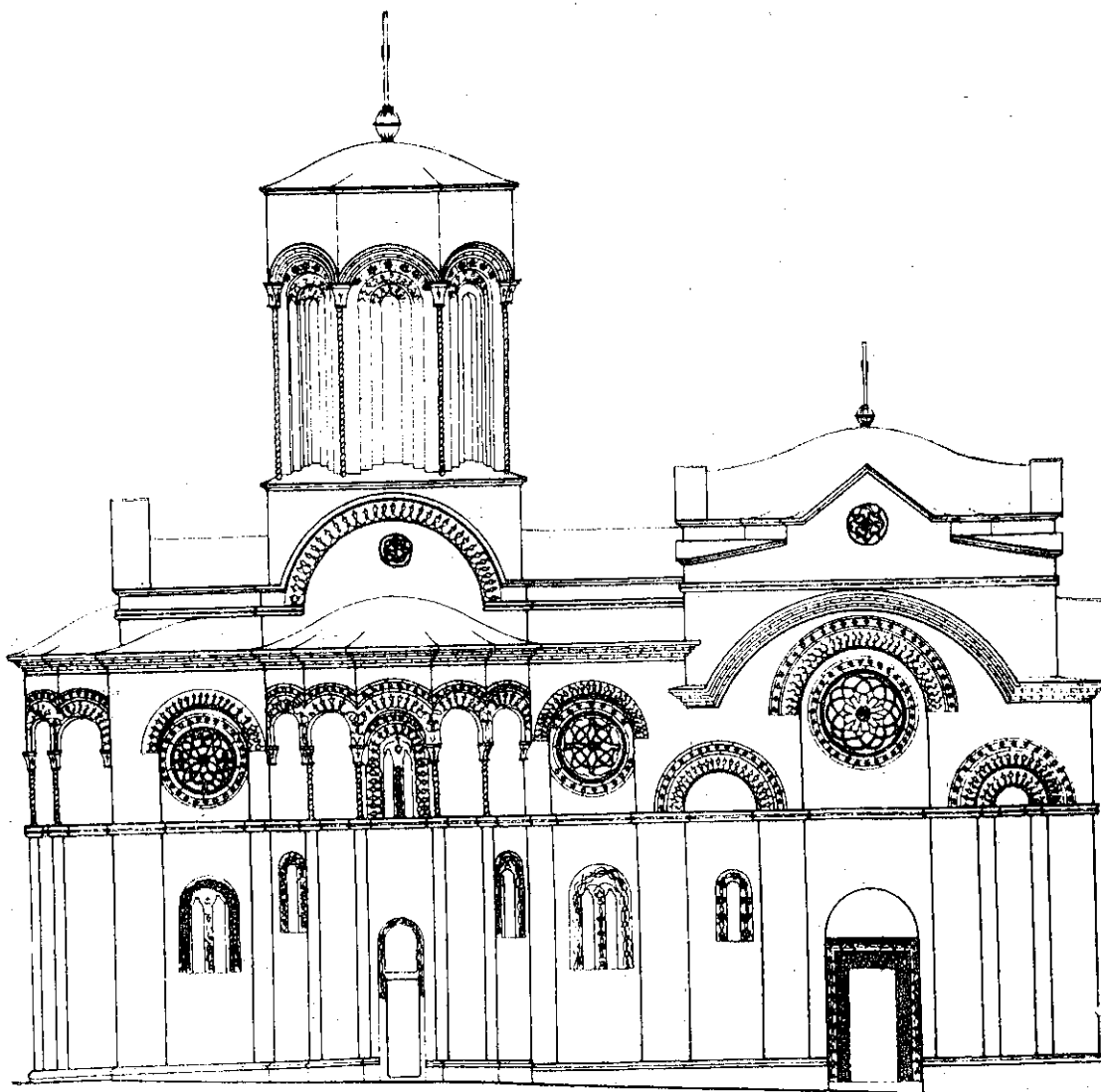
41. Љубостиња, северна фасада — шема затеченог стања са назначеним изменама
