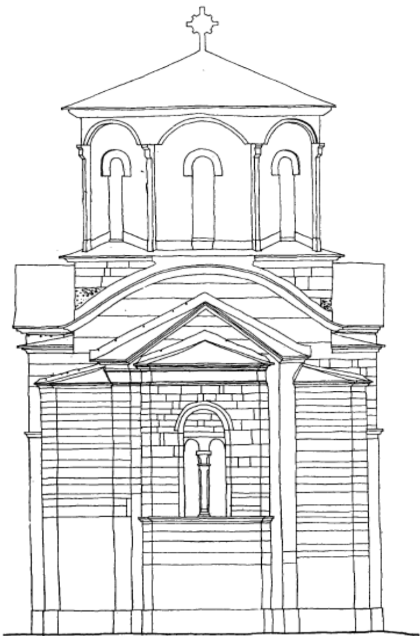
цртеж 22. Изглед блокова на источном зиду после обијања малтера.
